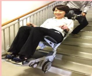
4つの車輪が動き、移動がむずかしい階段を人が歩くように昇り降りできる福祉用具です。
